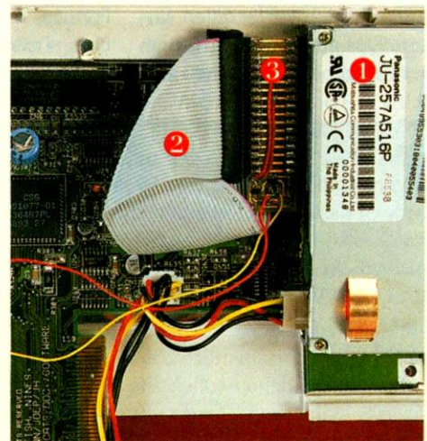
Eingefügt: Zwischen Laufwerk ① und Bus-Kabel ② steckt die Elektronik ③ des Kits
